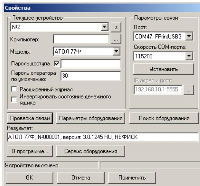
6. Нажать кнопку «Проверка связи». В строке «Результат» будет отображено наименование модели ККТ, ее заводской номер, версия программного обеспечения и статус регистрации. Аналогичная информация будет отображена в строке заголовка Утилиты регистрации ККТ.
