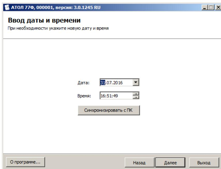
4. В поля «Дата» и «Время» ввести соответствующие значения или заполнить поля значениями из ПК, нажав кнопку [ **Синхронизировать с ПК** ]. Затем нажать кнопку [ **Далее** ].
